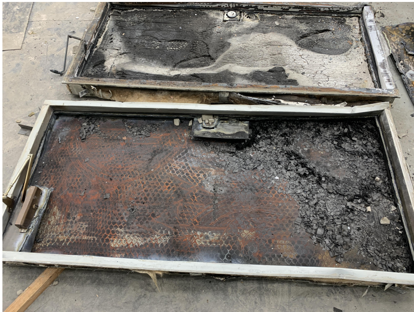
< 가열종료 후 시험체 내부 >
